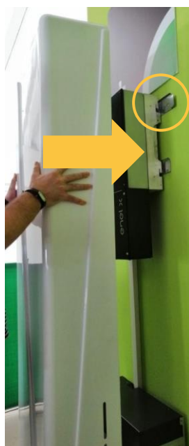
Soulever la coque en la rapprochant des brides de fixation
