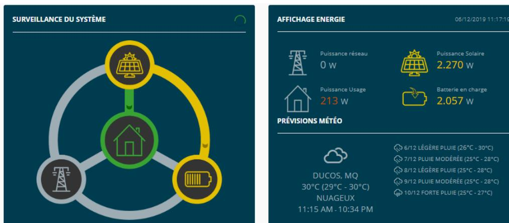
Cette section permet de visualiser son **autoconsommation en temps réel**. Le schéma de gauche représente l'état actuel du système et les flux d'énergies en cours.
