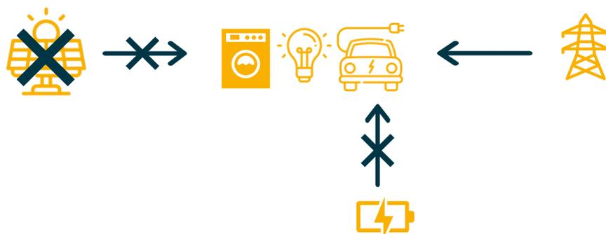
Schéma du fonctionnement en mode « Maintenance »
